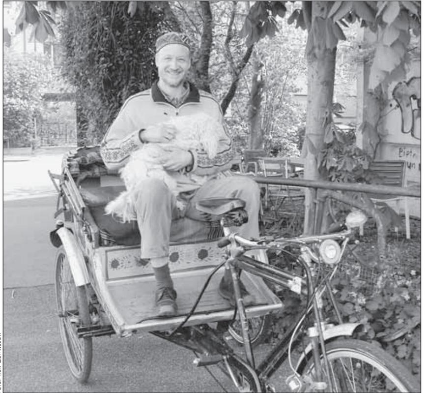
schwärmt von der Robustheit des Produkts. Das Fahrrad ist mit zusätzlichen Stangen verstärkt, und die Räder laufen auf doppelt so vielen Speichen. Am Chassis sei nie etwas defekt gewesen; auch das aufklappbare Dach, das die Passagiere vor Regen schützt, ist noch im Originalzustand.
